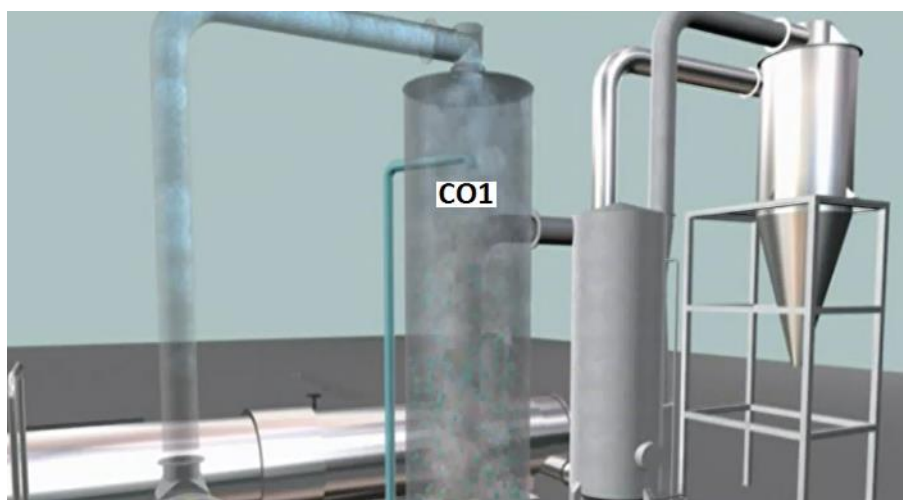
Figura nr. 2-74 Condensatorul (C1), ventilator (B2) aferente liniei de uscare a nămolului
