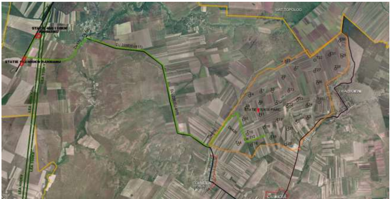
Fig. 1 – amplasare turbine si traseu electric pe ortofotoplan
