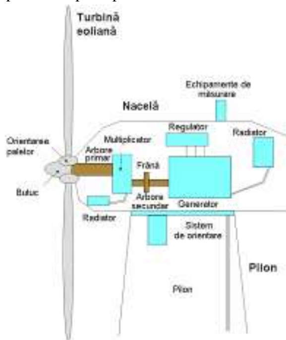
Componente principale turbine eoliene
