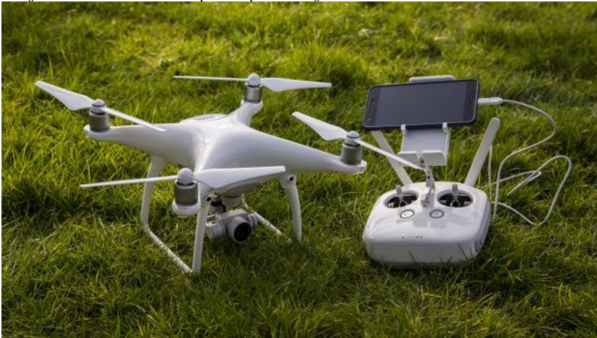
Figura 30 – Drona DJI Phantom 4 folosita la preluarea si prelucrarea imaginilor aeriene din zona studiata
