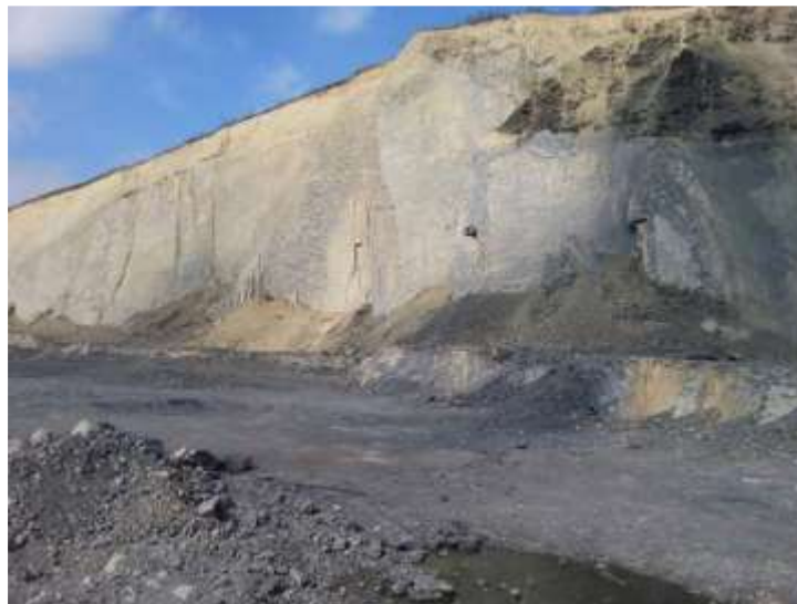
Fig.26 - Halda formata din dezagregarea naturala si rostogolirea a rocilor calcaroase la baza Taluzului nordic
