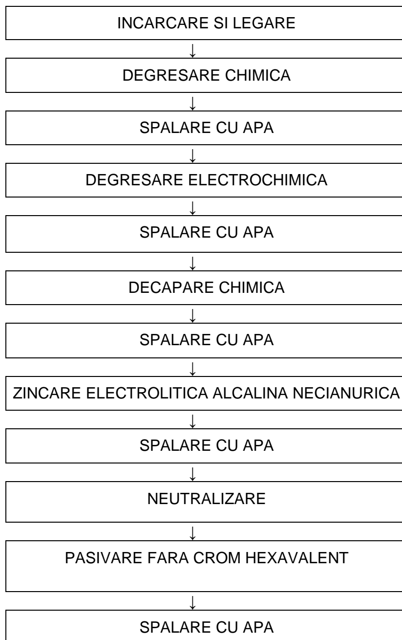
Figura nr. 38. Schema fluxului tehnologic la zincare electrolitica
