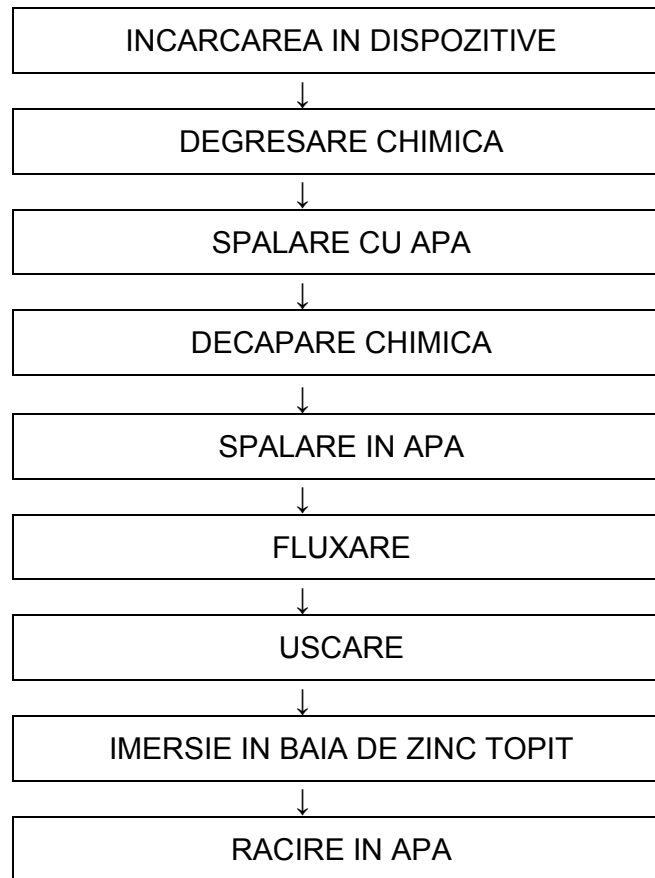
Figura nr. 37. Schema fluxului tehnologic la zincarea termica
