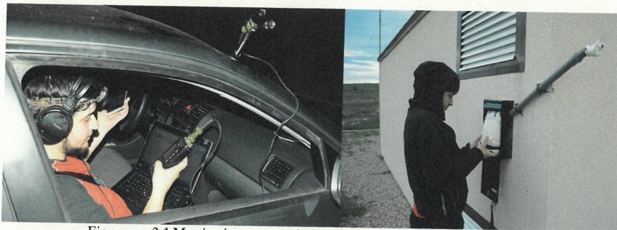
Figura nr. 2-1 Monitorizarea acustică (stânga – mobilă, dreapta – statică)
