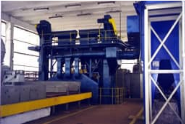
Figura 11 – Linia de sablare – vopsire (pasivizare) – Sectia Debitare
