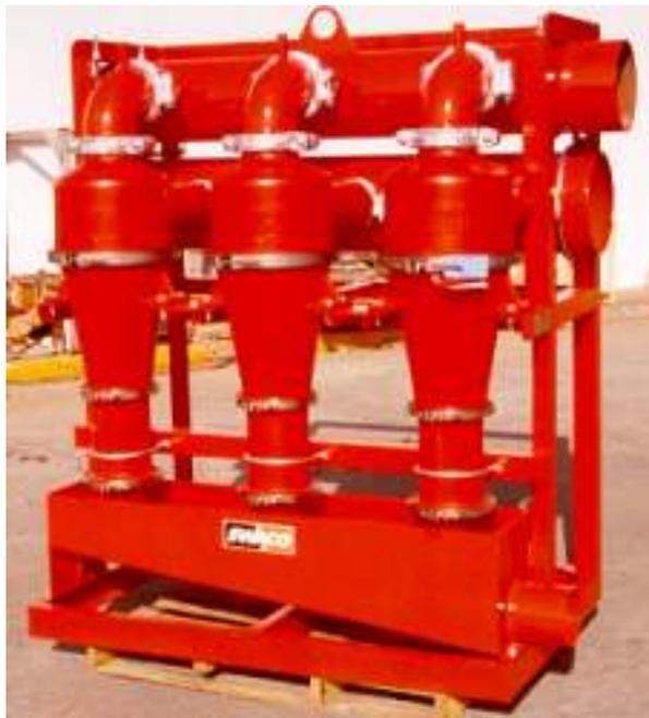
**Separatoarele centrifugale** sunt dispozitive destinate să îndepărteze barita din fluidul de foraj prelucrat, în vederea recuperării ei (particule solide cu diametru mai mare de 10  $\mu$ m).
