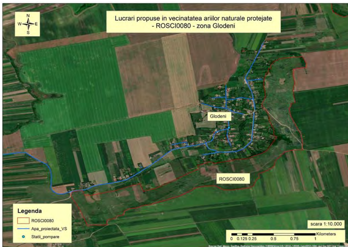
Figura 53 Amplasarea lucrarilor proiectului in raport cu aria naturala protejata ROSCI0080 Fanaturile de la Glodeni
