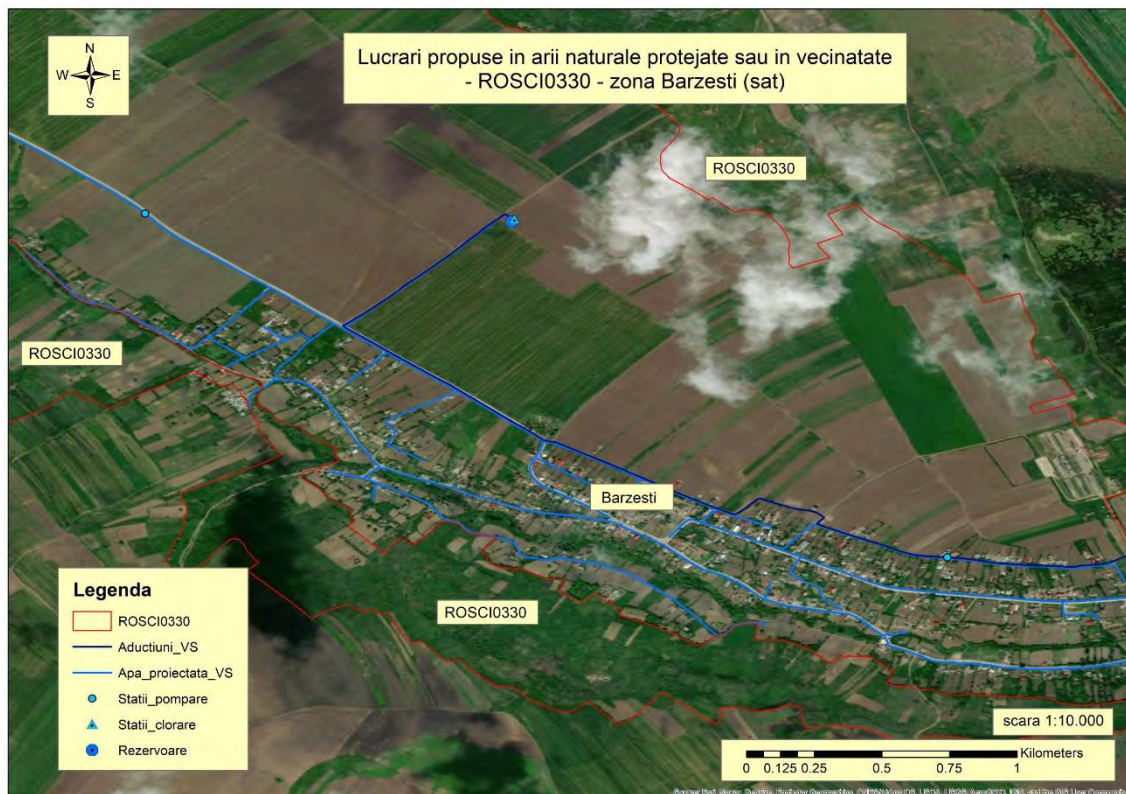
Figura 43 – Amplasarea lucrarilor proiectului in raport cu ariile naturale protejate –ROSCI 0330 – zona de intersectie/vecinatate cu aria protejata (zona Barzesti)
