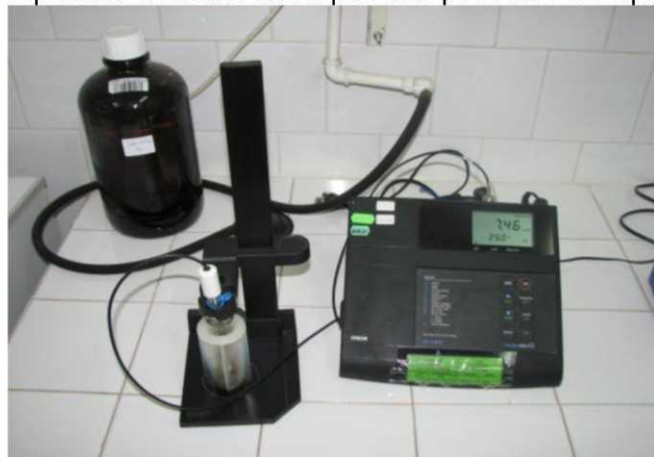
pH-metru ORION pentru determinarea pH-ului probelor de apă, sol și precipitații
