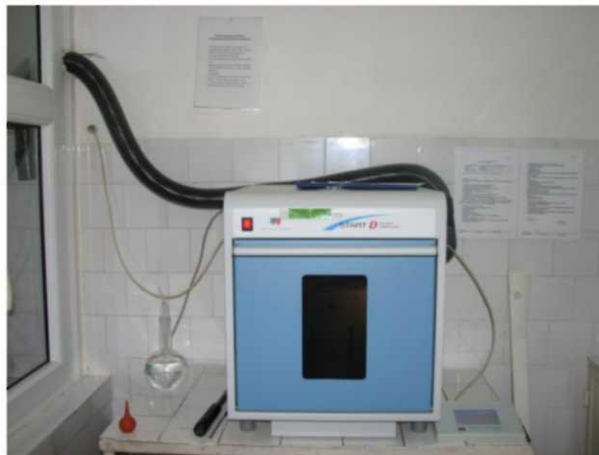
Cuptor cu microunde START D - folosit pentru mineralizarea probelor, în vederea determinării metalelor
