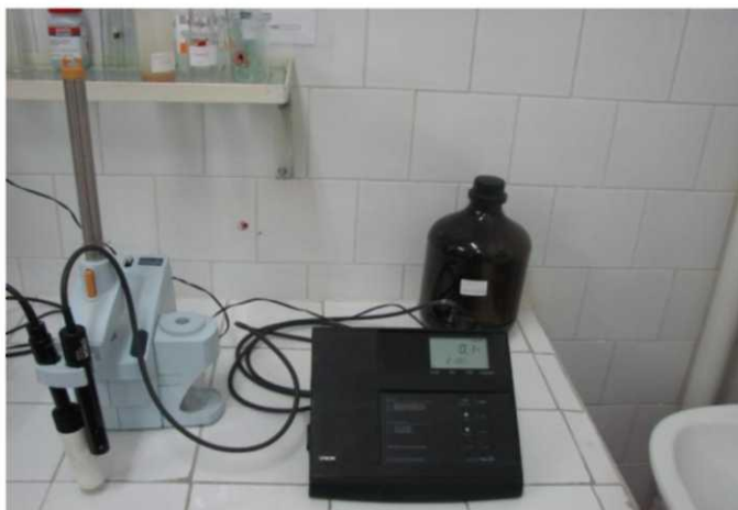
Conductometru ORION pentru determinarea conductivității probelor de apă și precipitații.
