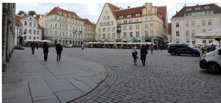
Figura 106: Exemplificări bune-practici: Spații “utilizate în comun”, partajate (“shared-space”), cu o slabă diferențiere a carosabilului și circulației pietonale (nivel comun, textură asemănătoare deși sesizabil diferențiată), în zone centrale și/sau comerciale sau de agrement
