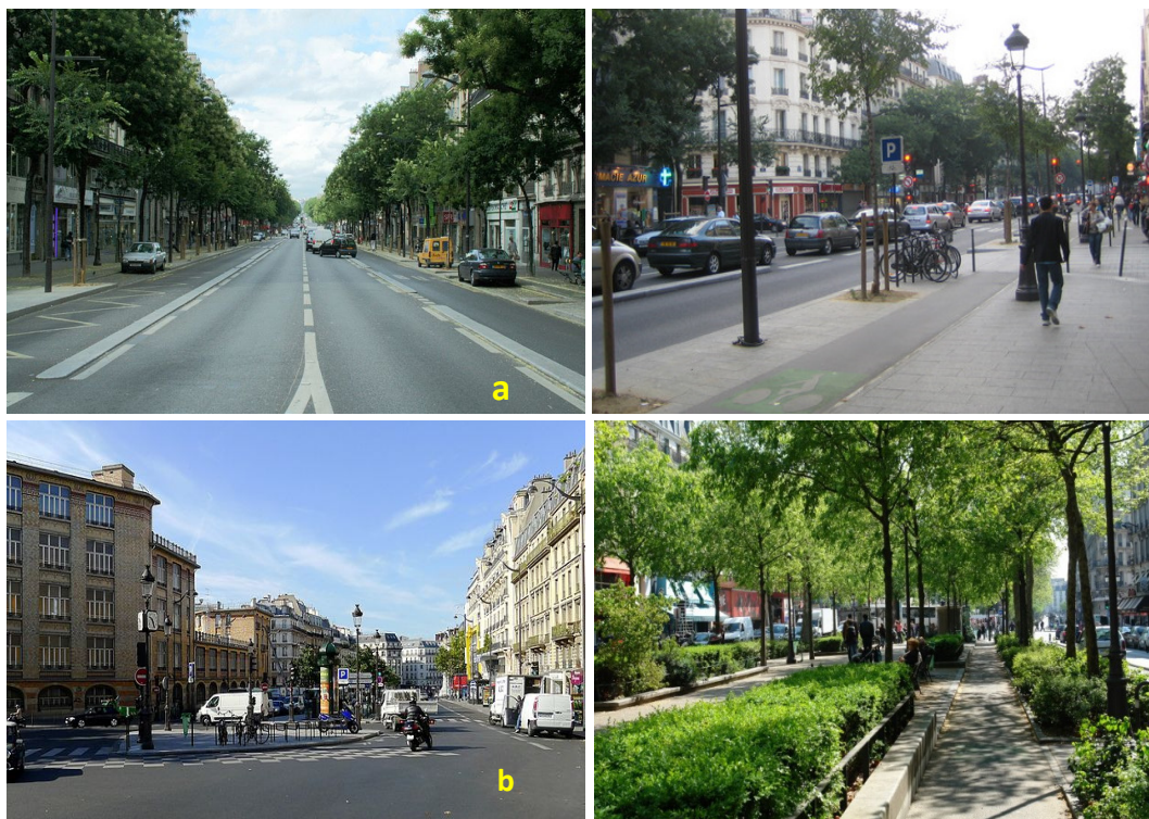
Figura 121: Exemplificări bune-practici de reorganizare a arterelor de rang superior - Reamenajarea unor bulevarde în Paris (reducerea carosabilelor, lărgirea trotuarelor, crearea de piste pentru bicicliști, plantarea unor copaci etc.) a. Reamenajare Bulevard Magenta, Paris (2013); b. Reamenajare Bulevard Cilcy, Paris (2013)
