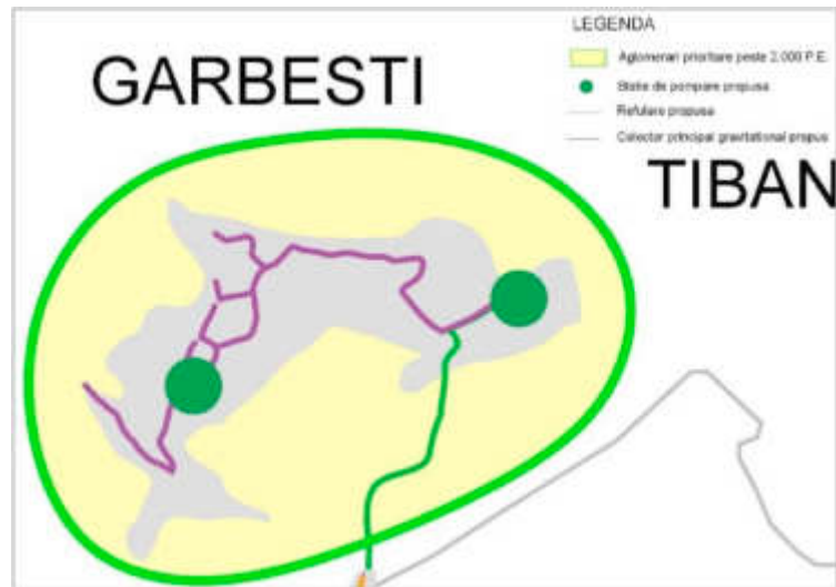
Figura 2-101 - Sistem de canalizare – Aglomerarea Garbesti
