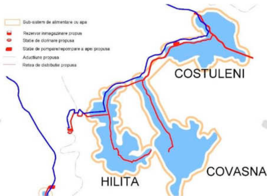
Figura 2-66 - Sub-sistemul de alimentare cu apă Costuleni
