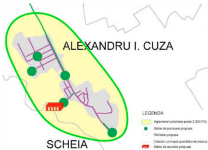
Figura 2-108 - Sistem de canalizare – Aglomerarea A.I. Cuza
