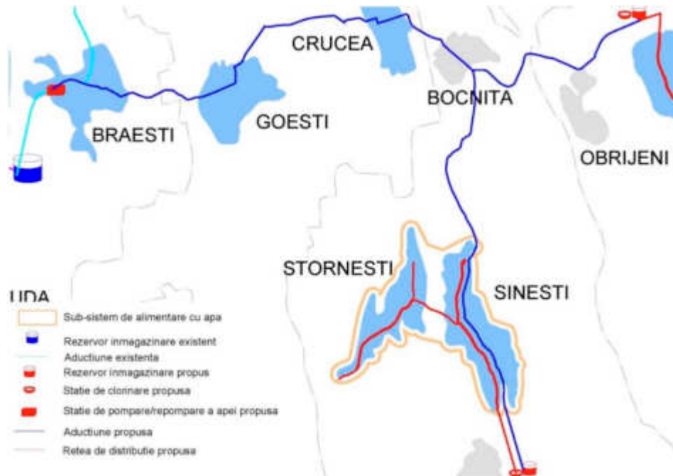
Figura 2-54 – Sub-sistemul de alimentare cu apă Sinesti
