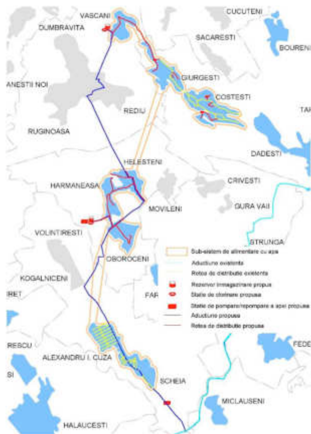
Figura 2-60 - Subsistemul de alimentare cu apă A.I. Cuza
