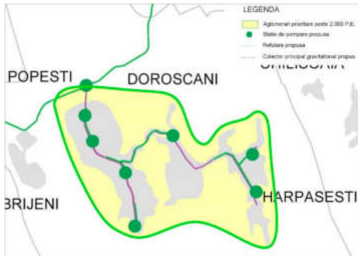
Figura 2-96 - Sistem de canalizare – Aglomerarea Popesti
