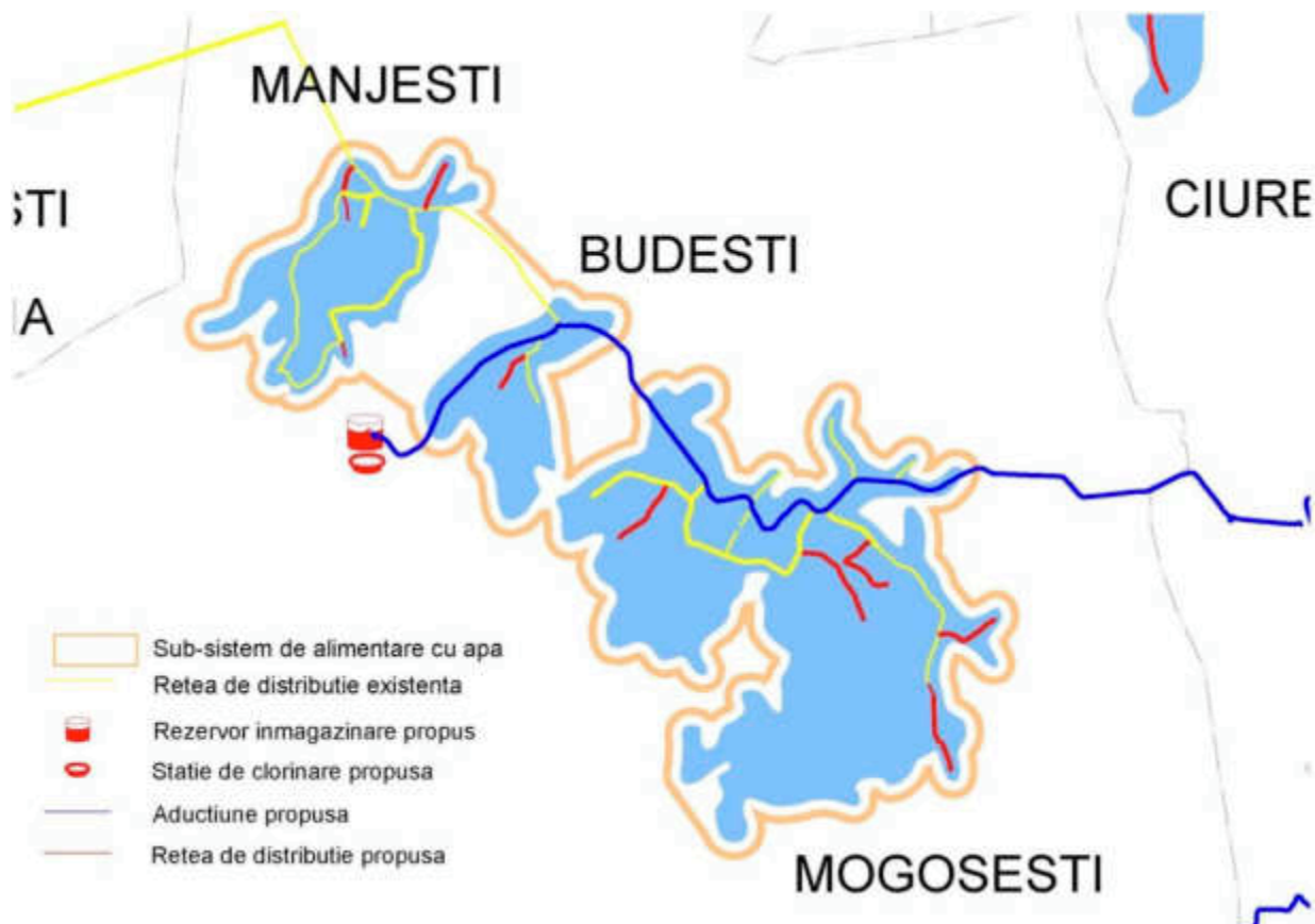
Figura 2-62 - Sub-sistemul de alimentare cu apă Mogosești
