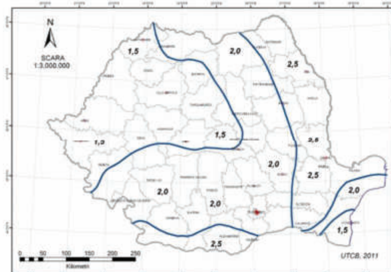
Figura nr. 7: Zonarea valorilor caracteristice ale incarcarii din zapada pe sol S_k , \text{kN/m}^2 pentru altitudini A \leq 1000\text{m}
