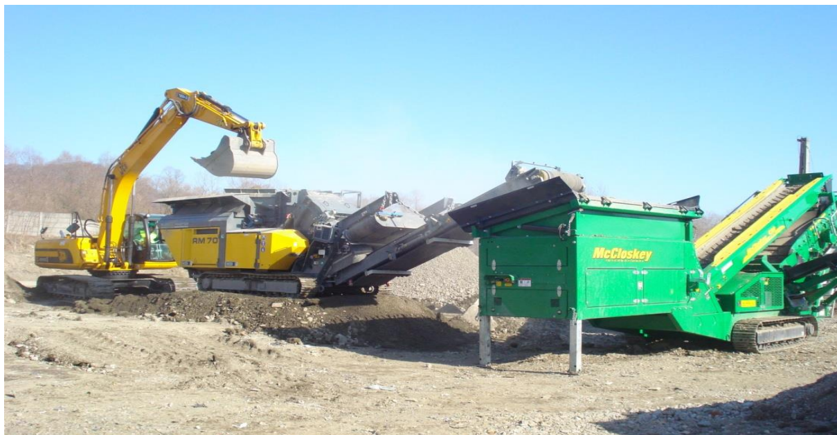
Fig. VII.1.1.6. Stație de preluare și prelucrare a deșeurilor provenite din construcții și demolări - Mediaș
