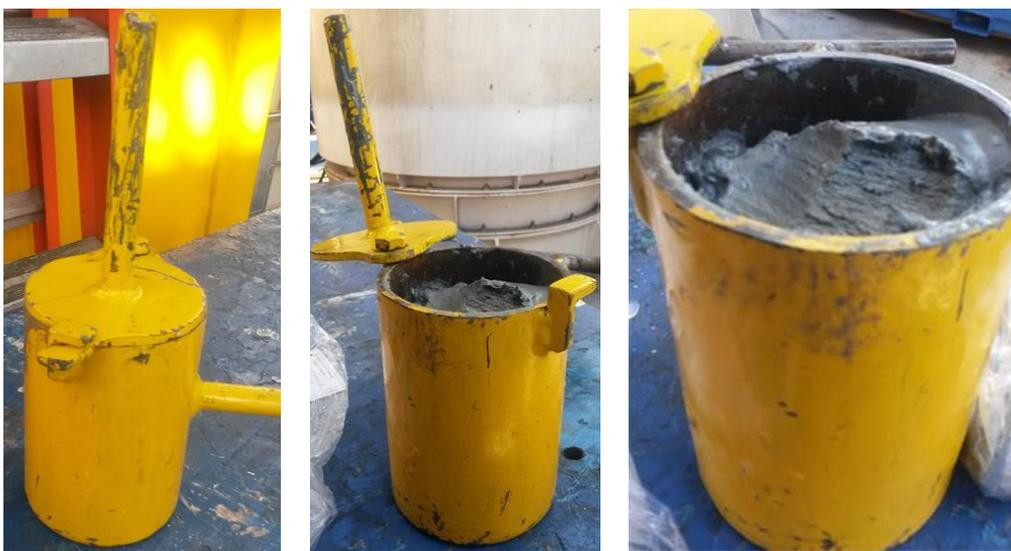
**Figura 9.** Sonda de prelevare a probelor de sediment (sonda care s-a atasat bratului ROV, foto: G. Paraschiv)
