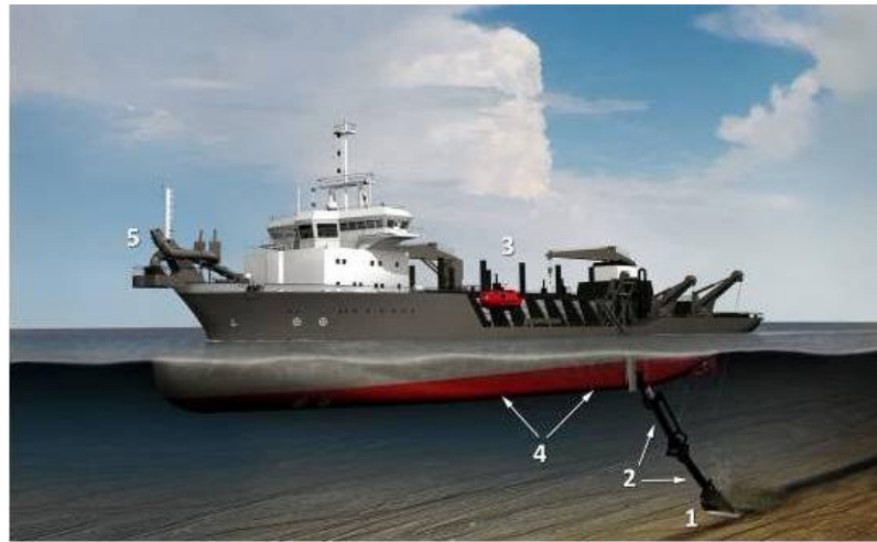
Fig. 2.14 – Operatiunea de incarcare a unei dragi TSHD (www.boskalis.com)
