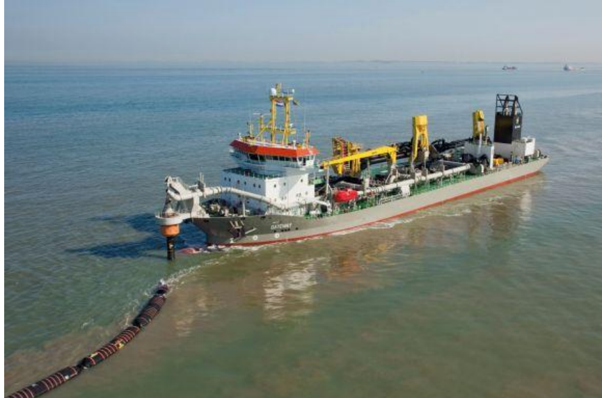
Fig. 4 – Pompare la tarm prin conducta (www.boskalis.com)
