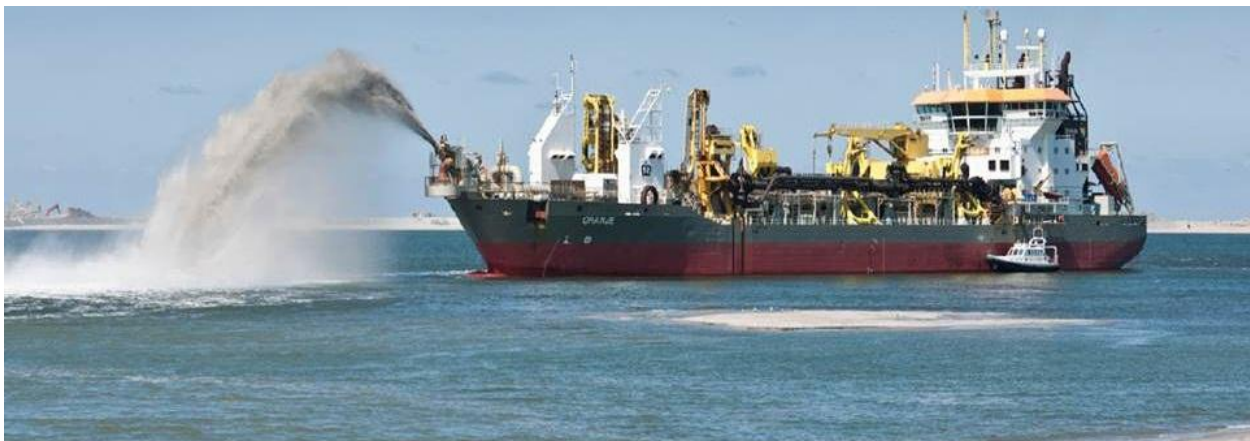
Fig. 2.16 – Pompare la tarm prin metoda rainbow (www.boskalis.com)
