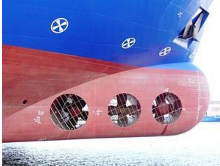
Fig. 2.10 – sistem de stabilizatoare de curs (Bowthruster)
