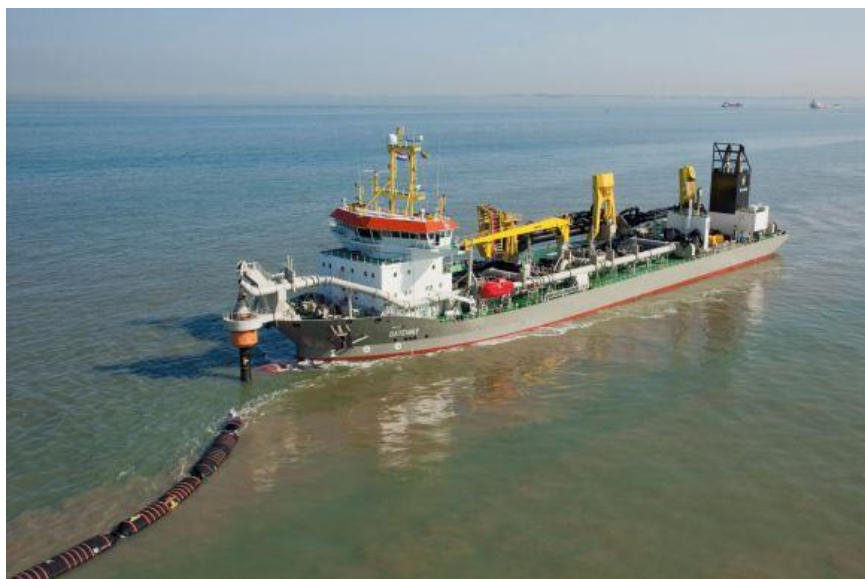
Fig. 4 – Pompare la tarm prin conducta (www.boskalis.com)
