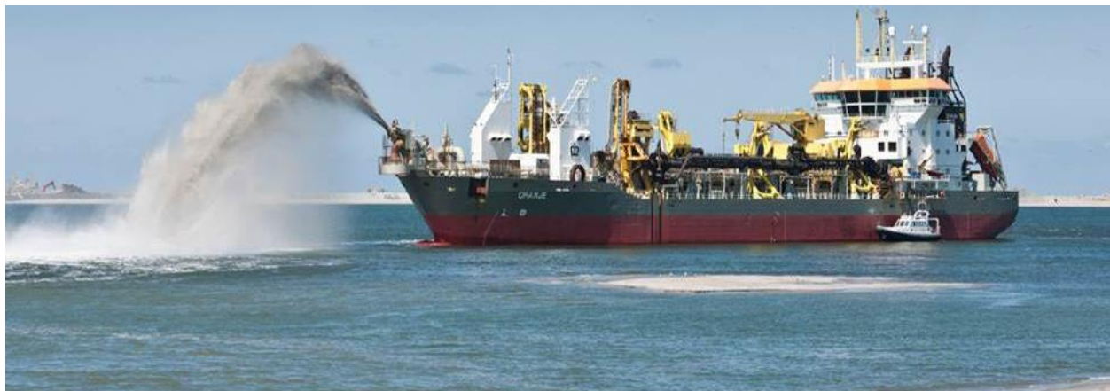
Fig. 2.16 – Pompare la tarm prin metoda rainbow (www.boskalis.com)
