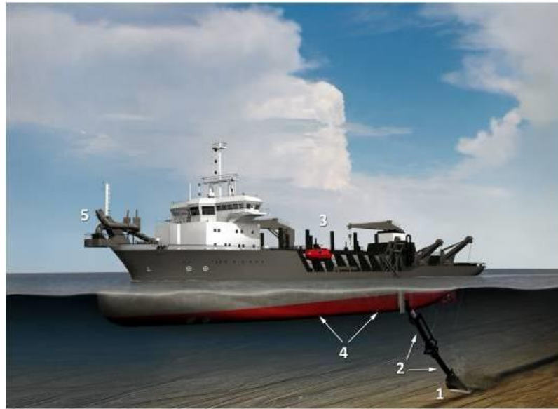
Fig. 2.14 – Operatiunea de incarcare a unei dragi TSHD (www.boskalis.com)
