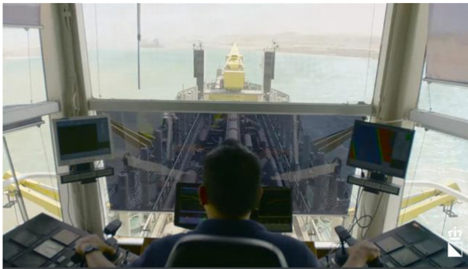
Fig 2.9 – Poarul de comanda al operatiunii de dragare (boskalis.com)
