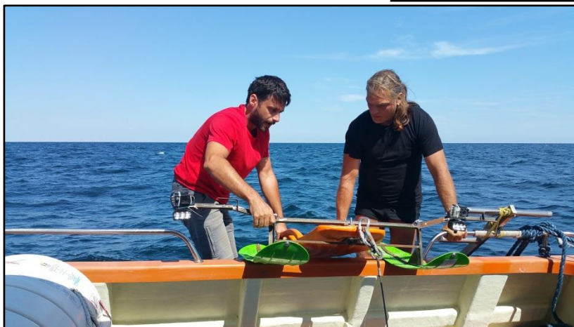
Fig. 5.14. Sanie submersa pentru inregistrare imagini subacvatice la adâncimi de pâna la 100m.
