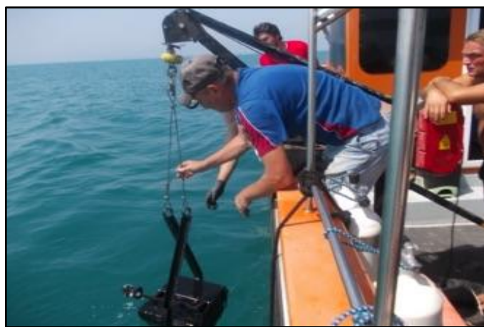
Fig. 5.13. Bodengreifer cu camera video subacvatica atasata manipulat cu o biga mobila.
