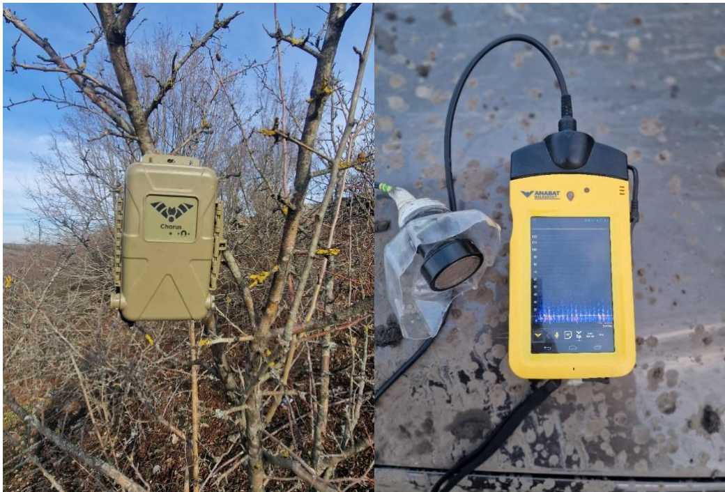
Figura 23. Detector manual pentru transectele de ultrasunete – Tip Anabat Walkabout cu GPS incorporat (dreapta), Detector static – Tip Anabat Chorus cu GPS incorporat (stânga)
