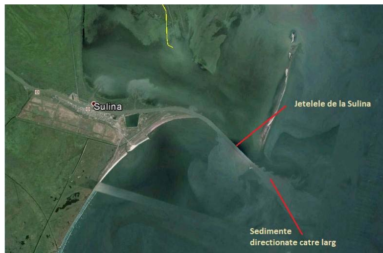
Figura 1.1 - 2 - Jetelele din zona Sulina - dirijarea aluviunilor inspre larg
