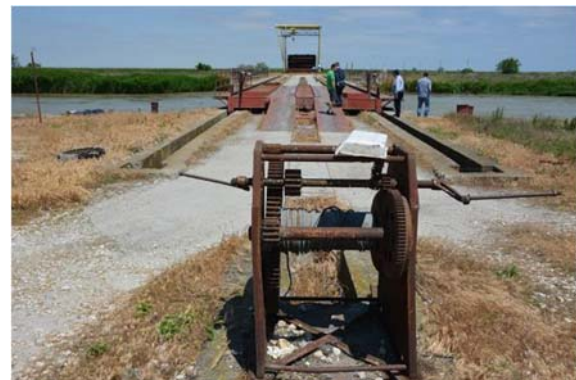
Troliu manual de manevra a podului metalic mobil situata in zona de tranzit a navelor tehnice
