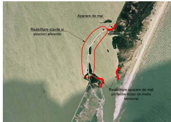
Figura 1.1 - 4 - Zona Stavilar (stavilar Periboina) – Situatia proiectata Prezentare in plan a situatiei existente si situatiei proiectate
