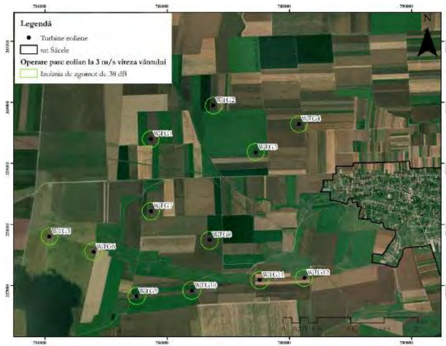
Figura nr. 7-31 Rezultatul modelării dispersiei zgomotului pentru o viteză a vântului de 3 m/s
