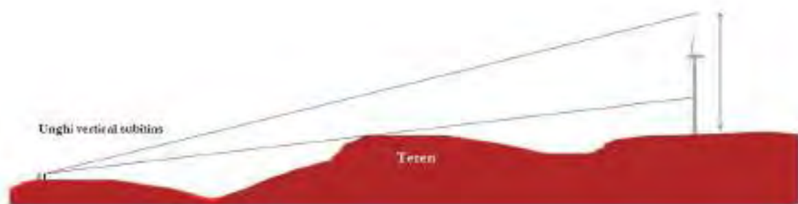
Figura nr. 7-53 Reprezentare a modului de calcul al unghiului vertical subîntins (Preluat din Manualul de utilizator WindPRO 3.6)
