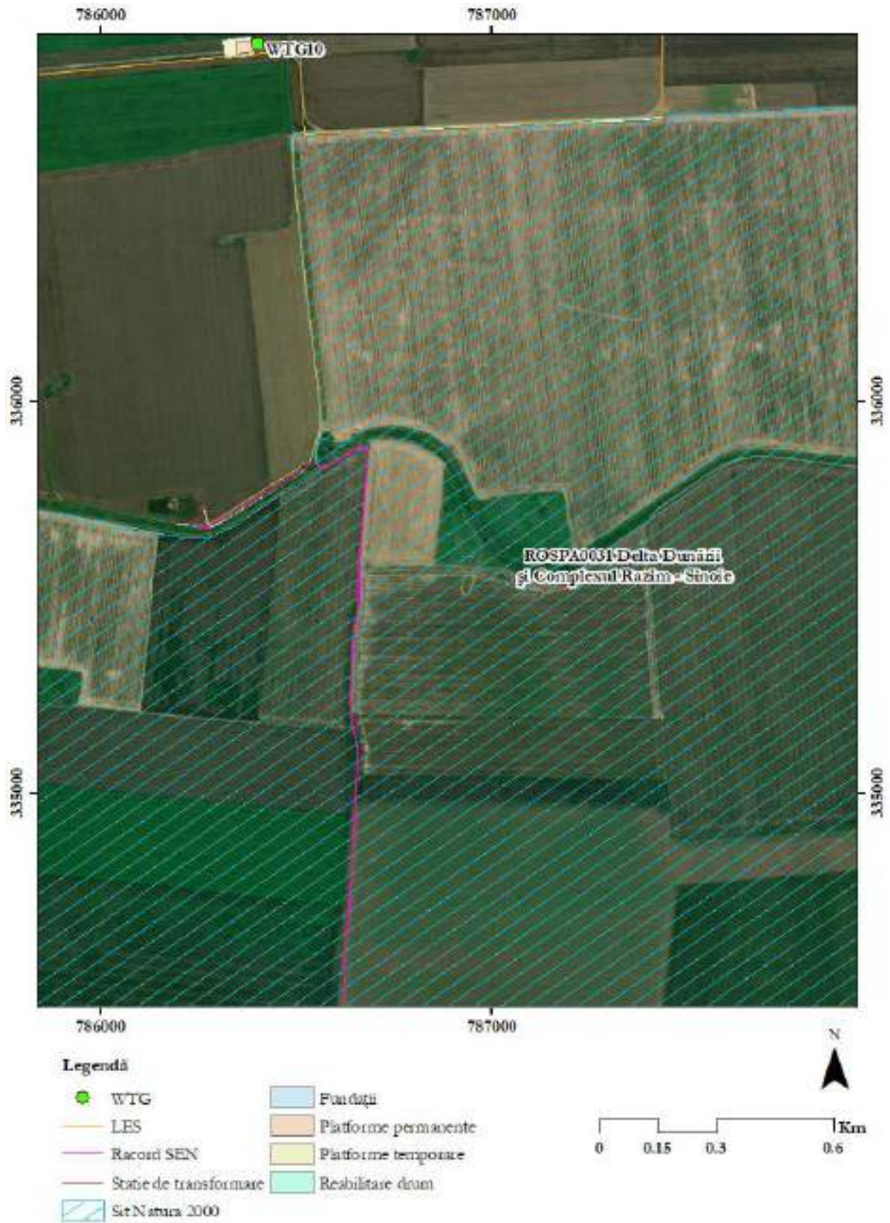
Figura nr. 2-11 Intervențiile propuse în situl ROSPA0031 Delta Dunării și Complexul Razim-Sinoie (LES și conectarea la SEN)
