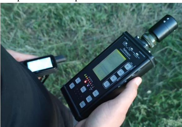
Inregistrarea ultrasunetelor cu Detectorul Pettersson D1000x
