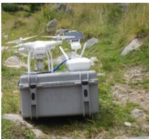
Figura 67. Drona DJI Phantom III-Advanced pregătită de zbor (stânga); Dronă DJI Matrice 600 PRO cu unitate LiDAR
