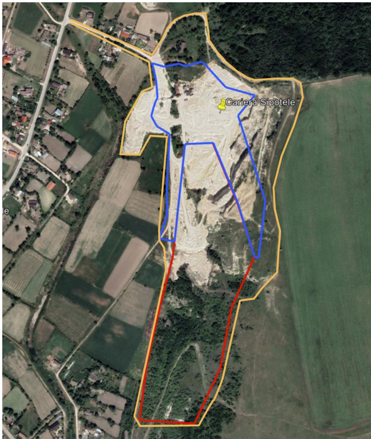
Figura 47. Amplasamentele la nivelul cărora se propune amplasarea perdelii de protecție din mesh
