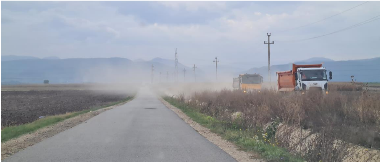
Figura 45. Ilustrarea impactului generat de transport pe un drum nestructurat manifest prin emisia de particule (praf)
