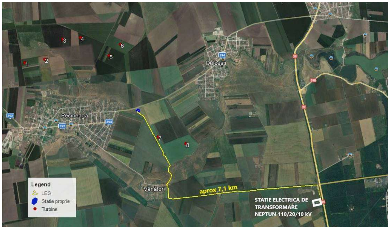
Traseul LES 110 kV din statia proprie parcului CEE Pecineaga pana in statia existenta Neptun
