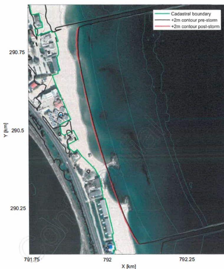
Pozitia inainte si dupa furtuna a conturului MN75+2m si limita cadastrala (modificata)
