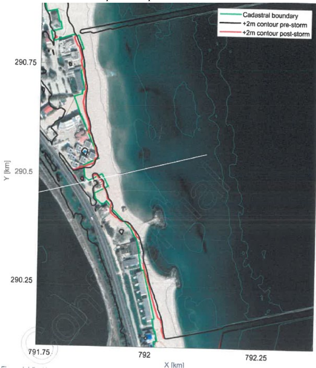
Pozitia inainte si dupa furtuna a conturului MN75+2m la limita cadastrala (modificata), dupa evenimentul cu perioada de recurenta de 100 de ani pentru Scenariul fara innisipare emersa
