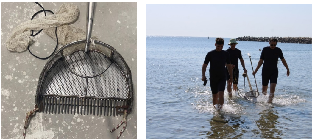
Figura V.2. – 5 – Draga tip Tellinero si imagini din timpul campaniei de eşantionare (foto original SCBIM AON)
