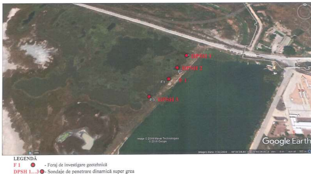
Figura 6 – Pozitionarea forajului si sondarilor pentru stabilirea calitatii terenului
