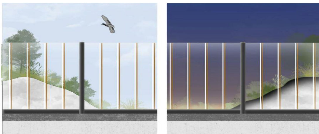
Figura nr. 5-7 Exemple de benzi serigrafiate aplicate pe suprafața panourilor fonoabsorbante
