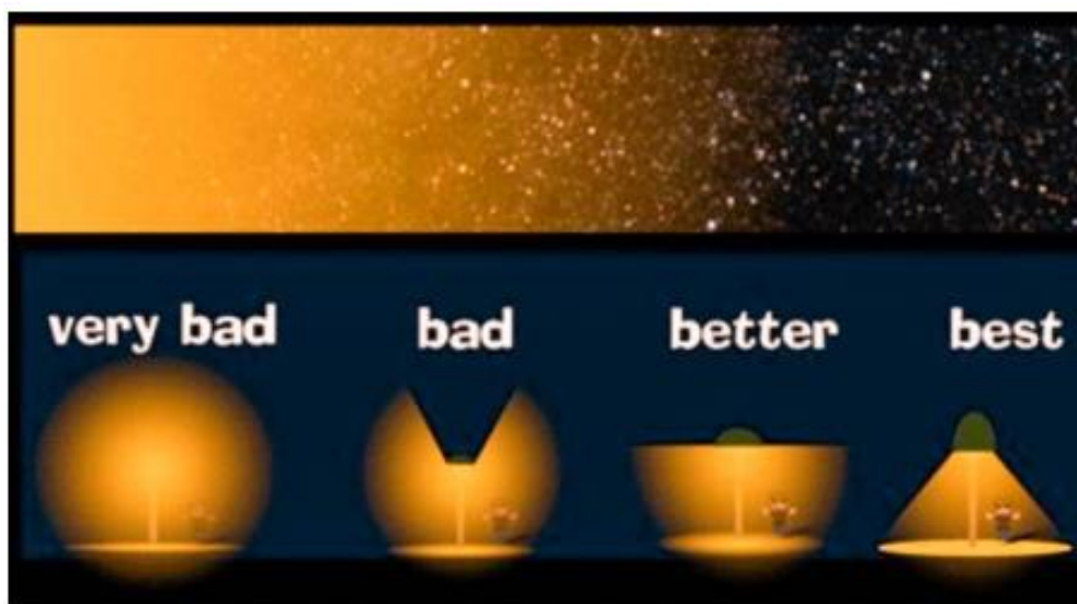
Figura nr. 5-4 Exemplu al unui sistem de iluminare adecvat pentru concentrarea dispersiei exclusiv asupra căii ferate (sursa: Rieswijk, 2014)
