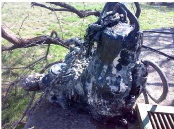
Foto 12. Pompa submersibila dintr-o statie de pompare ape uzate
