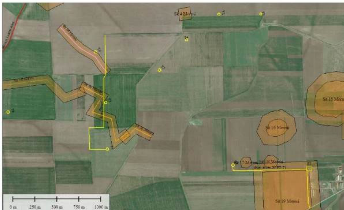
Pozitia turbinelor si a drumurilor de acces care intersecteaza zona de protectie
