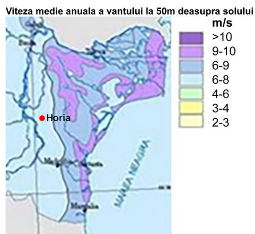
Figura 6. Viteza vântului (m/s) în Dobrogea și localizarea amplasamentului în zona eoliană de 6-8 m/s. Sursa: https://add-energy.ro/potențialul-eolian-al-romaniei/
