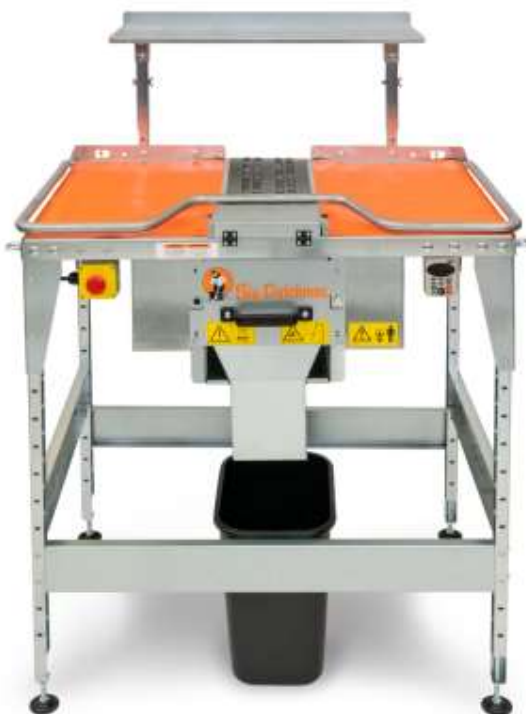
Fig.12 – Masa pentru sortare manuala oua
