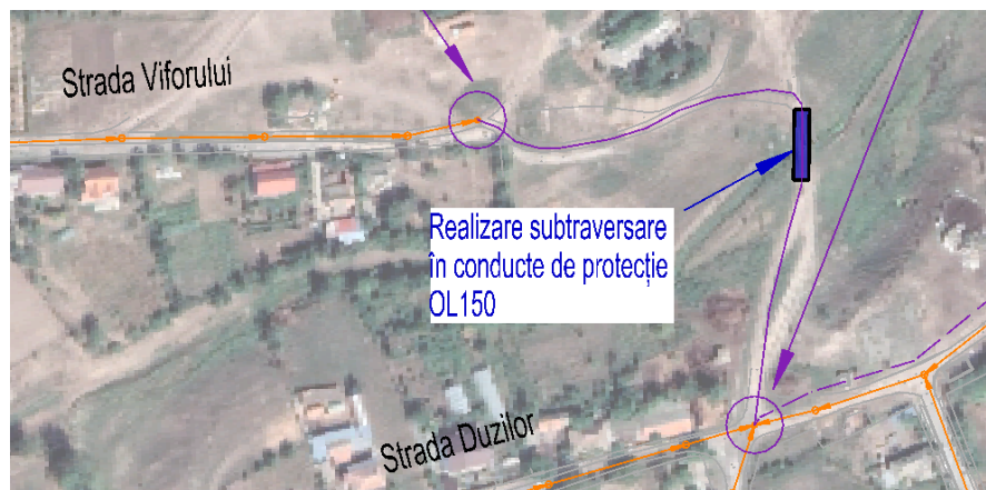
Figură 11 – Subtraversare strada Viforului
