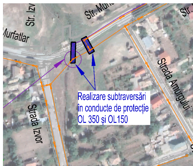
Figură 9 – Subtraversări strada Murfatlar
