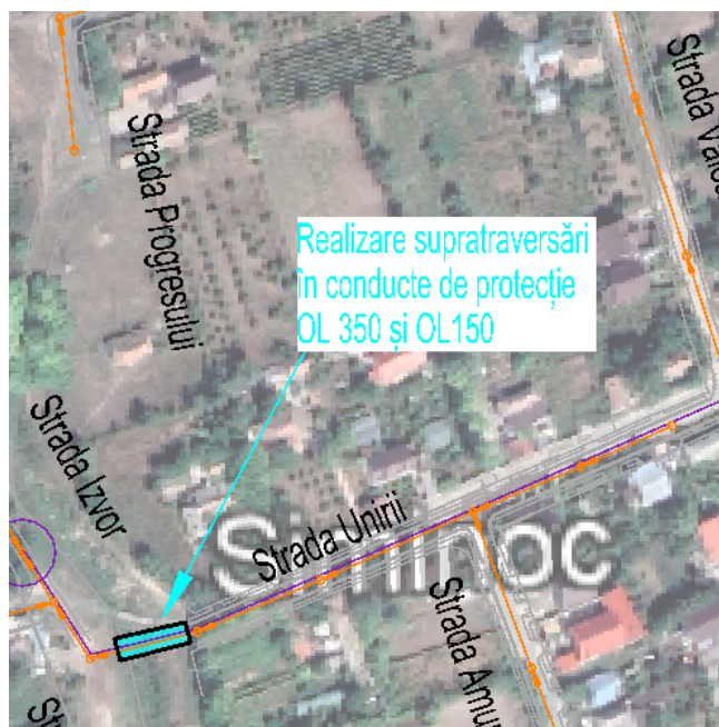
Figură 13 – Supratraversare strada Unirii
