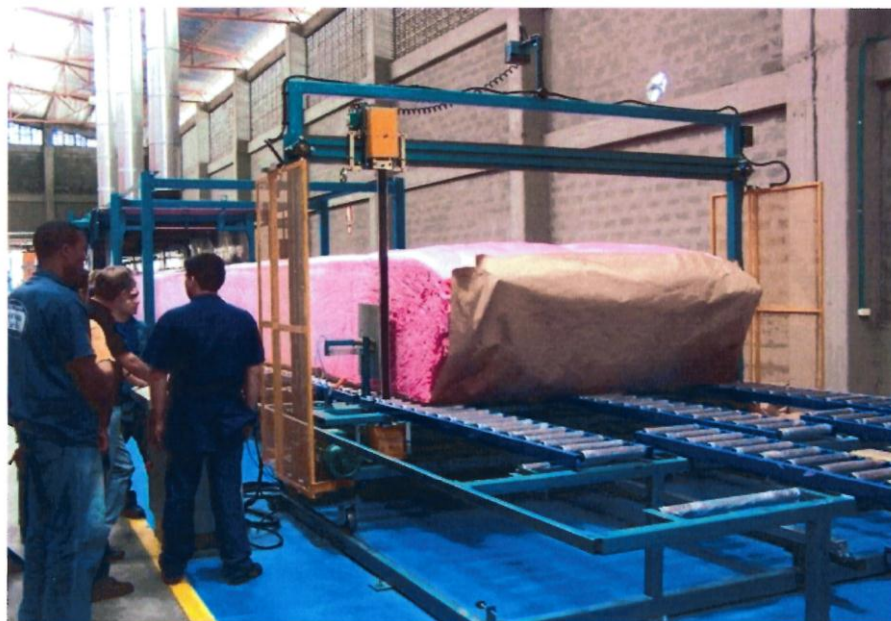
Figura nr. 3.5. Producerea blocurilor de spumă lungi ( http://www.cannonviking.com/en/prodotti/Continuous-Machinery/ )
