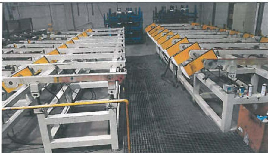
Masinile de rectificat fara centre sunt prevazute cu mese de evacuare tip plan inclinat si cu dispozitive de evacuare bara cu bara. Dupa rectificare piesa este preluata automat (senzor) de pe calea cu role de dispozitivul de evacuare.
