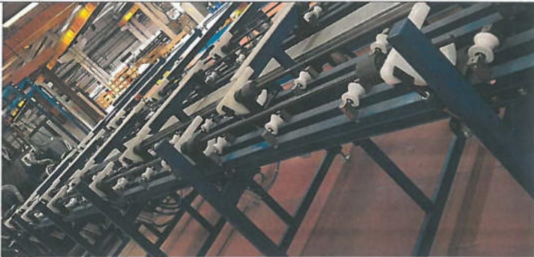
Intre bazin si masa de alimentare sunt pozitionate cate un grup de contacti care asigura transferul curentului permitand astfel crearea procedeului de depunere galvanica.Dupa trecerea prin bazin barele ajung la echipamentul denumit cale cu role evacuare care sunt evacuate automat.
