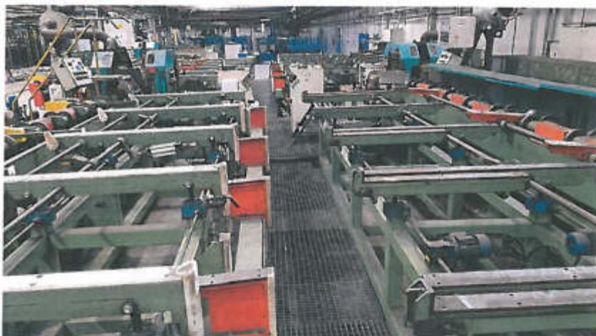
Masinile de rectificat fără centre sunt prevăzute cu mese de alimentare tip plan inclinat și cu dispozitive de alimentare bara cu bara. Cand o bara a parasit masa de alimentare mecanismul de incarcare actioneaza automat (senzor) incarcand o noua bara pe calea cu role. Calea cu role introduce piesa in masina de rectificat.
