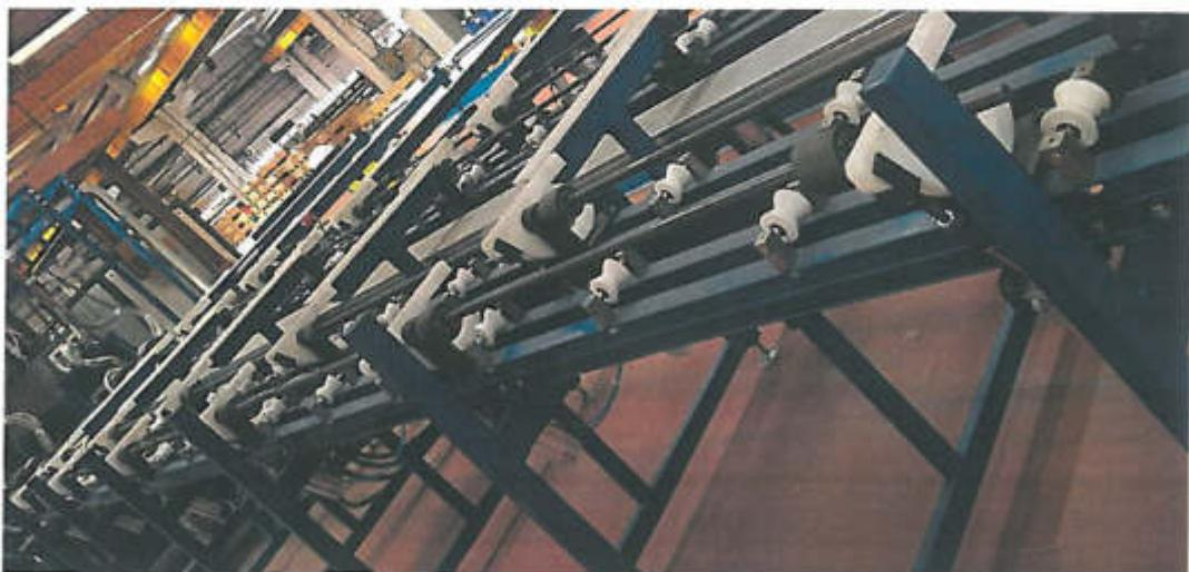
Intre bazin si masa de alimentare sunt pozitionate cate un grup de contacti care asigura transferul curentului permitand astfel crearea procedeului de depunere galvanica.Dupa trecerea prin bazin barele ajung la echipamentul denumit cale cu role evacuate care sunt evacuate automat.
