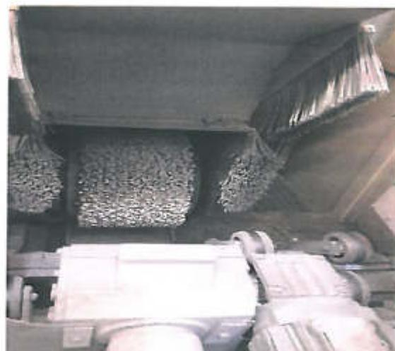
**8. Instalatie de tip Loeser 2 si Loeser 3 necesara pentru: -slefuire prin aschiere cu banda abraziva si perii**
