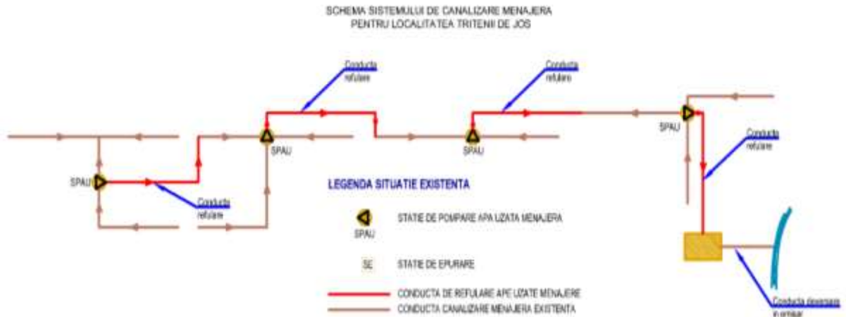
Figure 1-18 Schema sistemului de canalizare Trittenii de Jos și Trittenii de Sus
