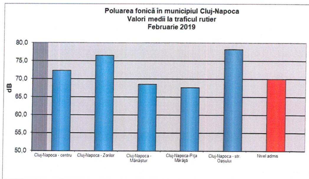
Figura 4.1. Rezultatele monitorizării nivelului de zgomot în Cluj-Napoca
