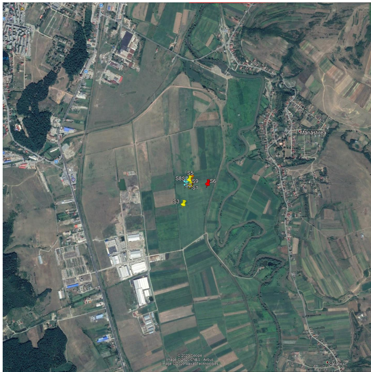
Figura 2 MG TEC Industry SRL - surse de poluanți: S1, S2, S3 - centrale termice (galben), S4, S5 - uscătoare de hârtie (portocaliu), S6 - incinerator (roșu), S7, S8, S9, S10 - sisteme recuperare praf (albastru).
