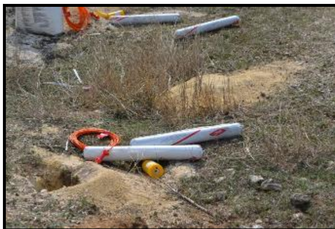
Material exploziv de tip Riogel si booster NONEL
