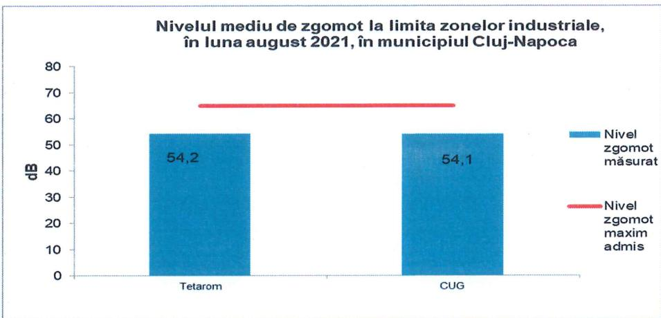
Figura 4.6. Nivelul de zgomot la limita zonelor industriale, în luna august 2021
