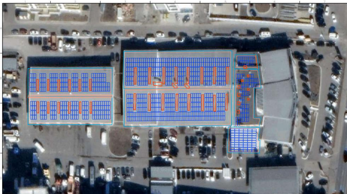
Fig. 2 Plan de situație – amplasare panouri fotovoltaice
