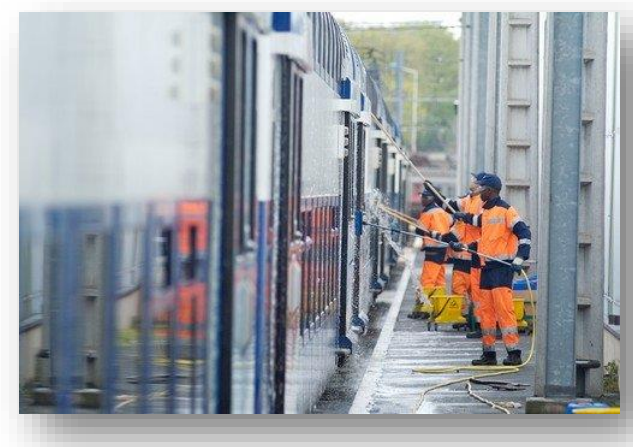
Figura 1.109. Exemple de zone amenajate pentru spălarea exterioară manuală a materialului rulant
