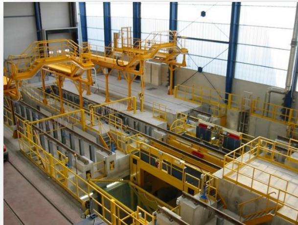
Figura 1.119. Exemplu de sistem hidraulic de înlocuire de boghiuri
