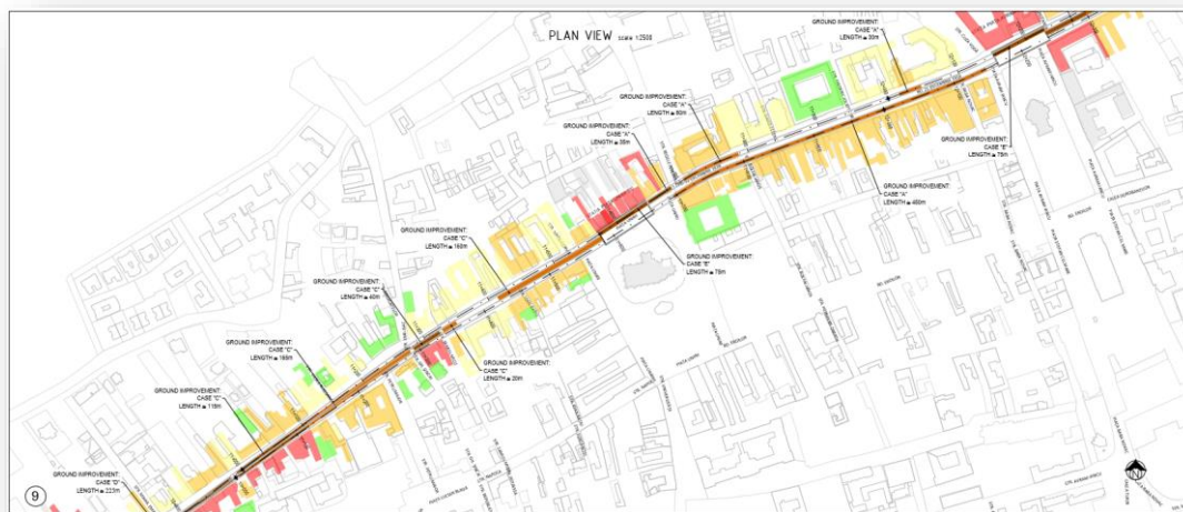
Figura 1.47. Daunele estimate pentru clădirile învecinate și aplicarea măsurilor de diminuare a daunelor - vedere 8
