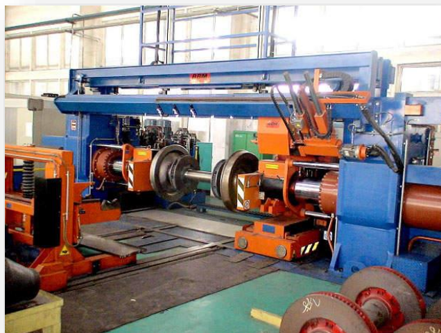
Figura 1.119. Exemplu de sistem hidraulic de înlocuire de boghiuri
