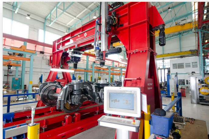
Figura 1.122. Exemplu de stand de încercare pentru boghiuri
