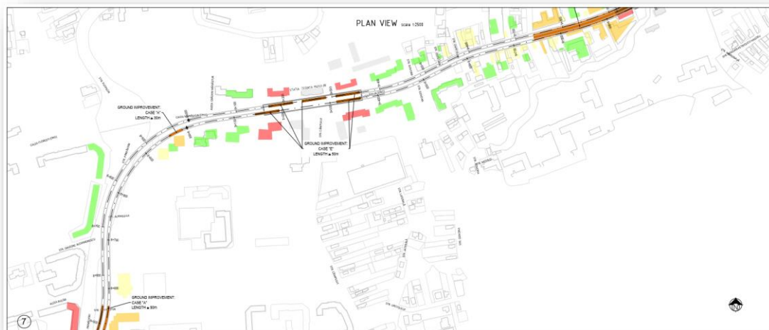
Figura 1.45. Daunele estimate pentru clădirile învecinate și aplicarea măsurilor de diminuare a daunelor - vedere 6
