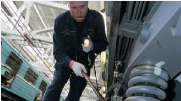
Figura 1.105. Exemplu de operațiune de mentenanță ușoară : inspecție a organelor de rulare
