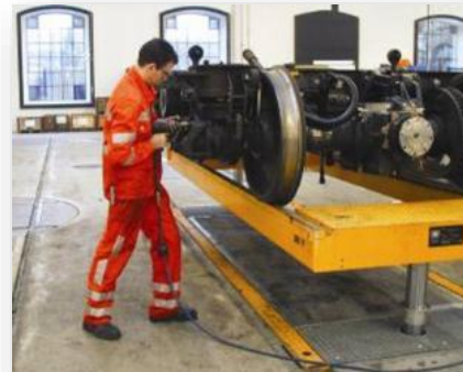
Figura 1.106. Exemplu de operațiune de mentenanță grea : revizie de boghiu
