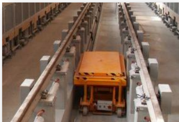
Figura 1.114. Exemplu de masă hidraulică în fosă
