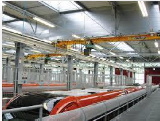
Figura 1.111. Exemplu de pod rulant instalat pe o linie de reparații ușoare
