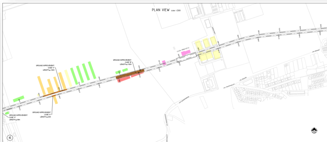
Figura 1.43. Daunele estimate pentru clădirile învecinate și aplicarea măsurilor de diminuare a daunelor - vedere 4
