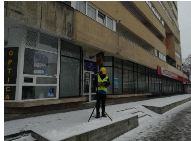
Foto 6.4. Măsurarea nivelului de zgomot
