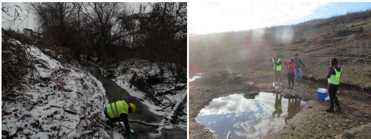
Foto 6.1. Prelevare probe apă de suprafață
