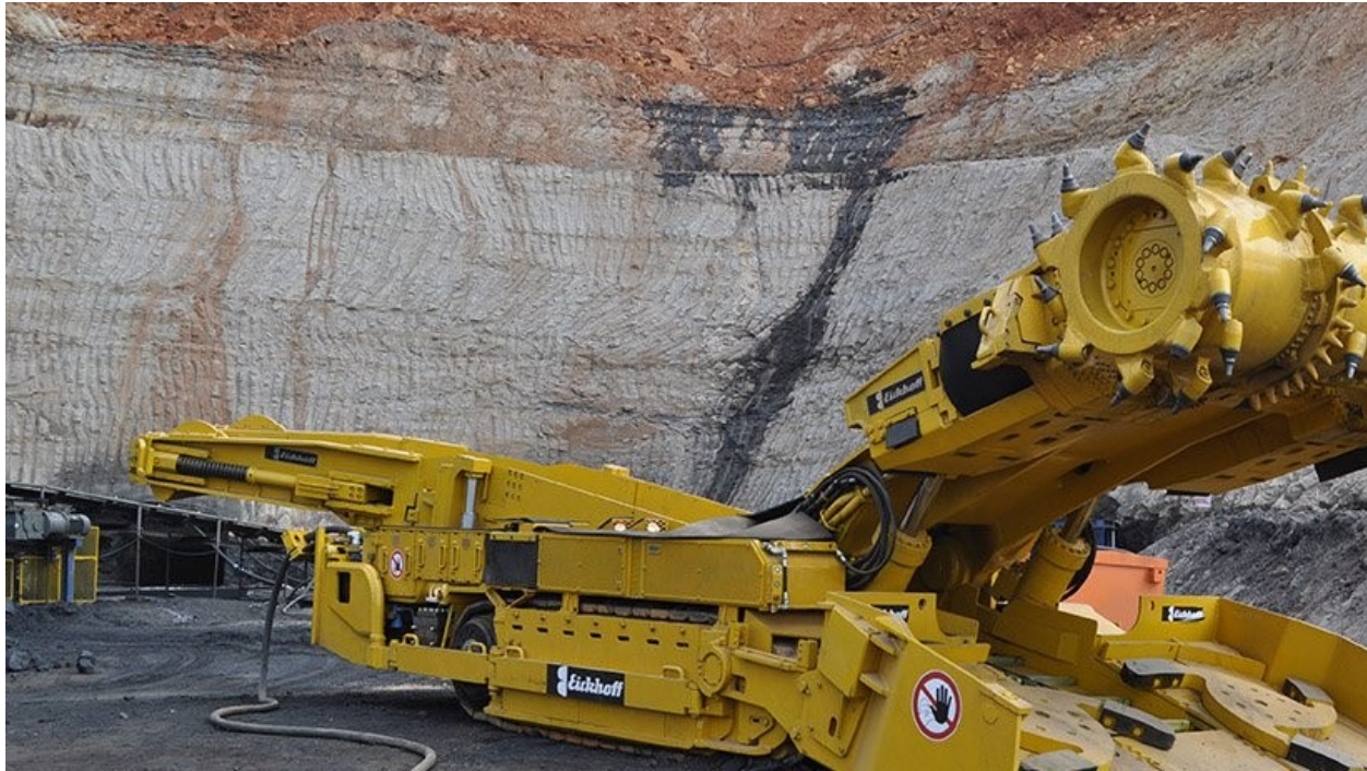
Fig.13. Model de combina cu care se poate realiza exploatarea sării gemă
